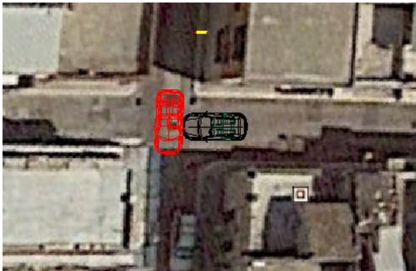
Figura 7 – Verosimile configurazione di impatto.
